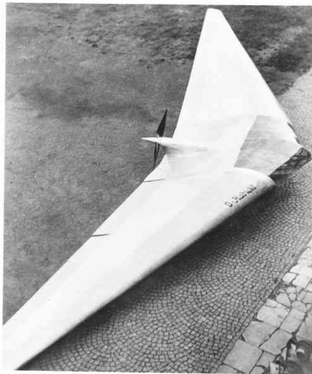
Nurflügel-Flugzeug Horten II mit HM 60 Motor
